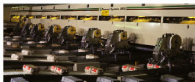
OP60 в работе на упаковочной станции. Эти сортировальные машины Moba и Diamond оснащены системами OP60
